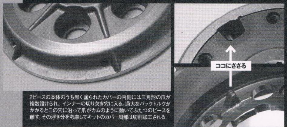
2ピースの本体のうち黒く塗られたカバーの内側には三角形の爪が複数設けられ、インナーの切り欠き穴に入る。過大なバックトルクがかかるとこの穴に沿って爪がカムのように動いてふたつのピースを離す。その浮き分を考慮してキットのカバー周部は切削加工される
