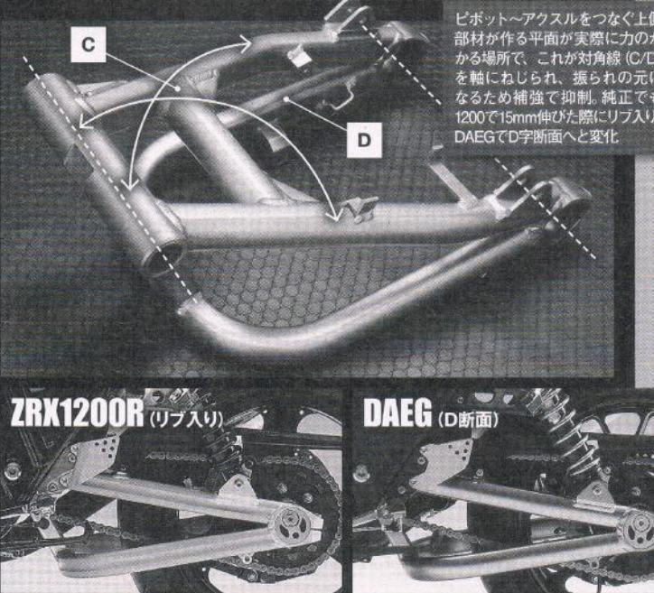
ピボット～アクスルをつなぐ上側部材が作る平面が実際に力のかかる場所で、これが対角線(C/D)を軸にねじられ、振られの元になるため補強で抑制。純正でも1200で15mm伸びた際にリブ入り、DAEGでD字断面へと変化
