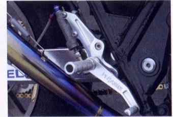
アルミ削り出しのステップはペガサスのオリジナル。ローレット加工が施された固定式ステップバーは、いかにもレーサーらしい。
