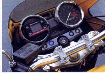
スピードメーターは輸出用の260km/hフルスケールに交換されているが、その上にヨシムラのテンプレーターが貼り付けてあるためにスピードは確認できない。今回のサーキット走行に合わせたの装備か、それともレーシングマシンの名残か。
