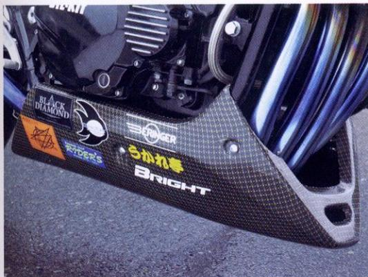
元がレーシングマシンだけに、アンダーカウルはレギュレーション的にも標準装備的なパーツ。A-TECH製カーボンケブラーのアンダーカウルは軽量で強度も十分。空力的なメリットとデザインを引き締める効果あり。
