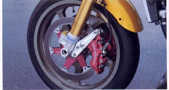
フロントブレーキにはベルリンガーの6ポッド・スーパーバイクキャリパーを装着。同じベルリンガーの6ポッドでも、2パットのエンデュランスタイプに比べて、この6パッドは入力初期の食い込みが格段に強力。リリース時の反応はスムーズで、コントロール性も高い。ディスクローターも同じくベルリンガーのレーシング・エアロナル。鋳鉄をベースにした化学合成キャストングだ。
