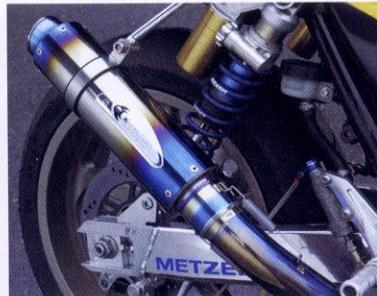
キャブレターはFCR39φ、マフラーは小径かつショートなMotoGPサイレンサーを装備したKファクトリー3Dチタン。パッフルを外した状態のエキゾーストは周囲の空気を震わし、乾いたサウンドを轟かせる。
