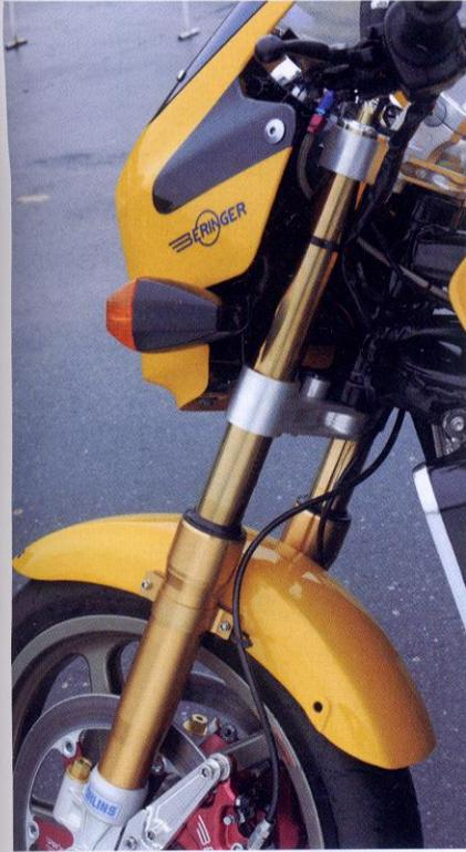
発売間もないロードスポーツ用のオーリンズ正立フォークを装備。オールペンされた車体色とのマッチングもピッタリだ。インナーチューブ径は43φでノーマルZRX1100/1200にもボルトオン装着できるのだが、ステムは上下共にトゥービー製のアルミ削り出しに交換されている。オフセットはノーマルと同じで、クランプの幅を大きく取ることによって大幅な剛性アップが図られている。
